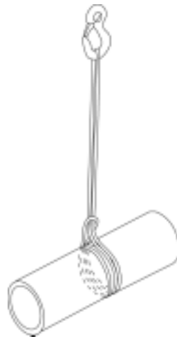
图 C.1 双匝扼圈连接
